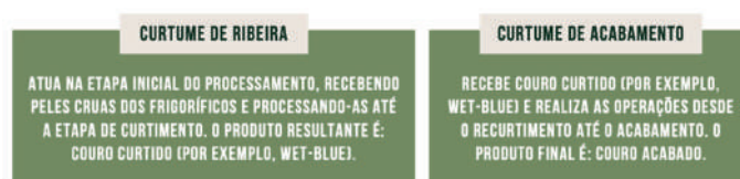
Figura 6 - Diferenças fundamentais entre curtume de ribeira e curtume de acabamento
