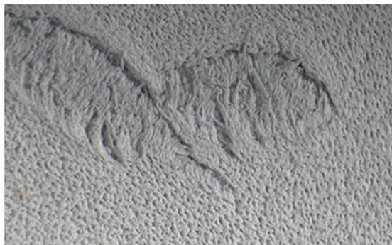
Foto 1 – immagine al microscopio di grain crack
