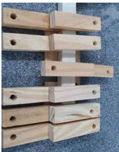
Figura 3 - Corpos de prova para análise de resistência ao cisalhamento
